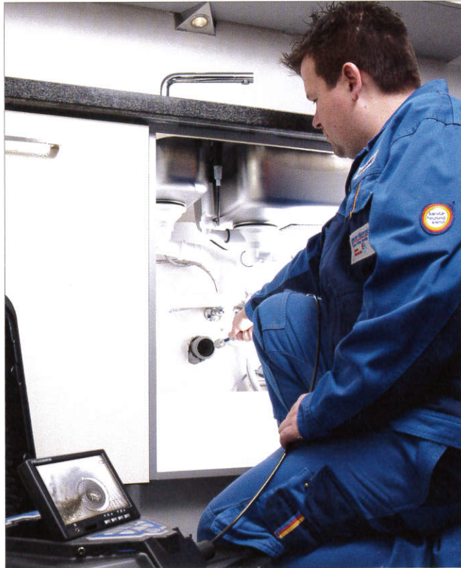
Der bis 3 bar wasserdichte, robuste Farbkamerakopf mit nur Ø 26 mm meistert selbst 87°- Bögen in Rohrleitungen von Ø 40 mm.
