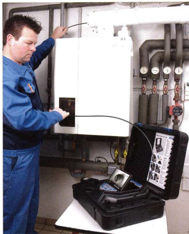
In den verschiedenen Bereichen der Schadensanalyse, wie z.B. der Abgasanlage ist die Servicekamera ein unerlässlicher Partner.
