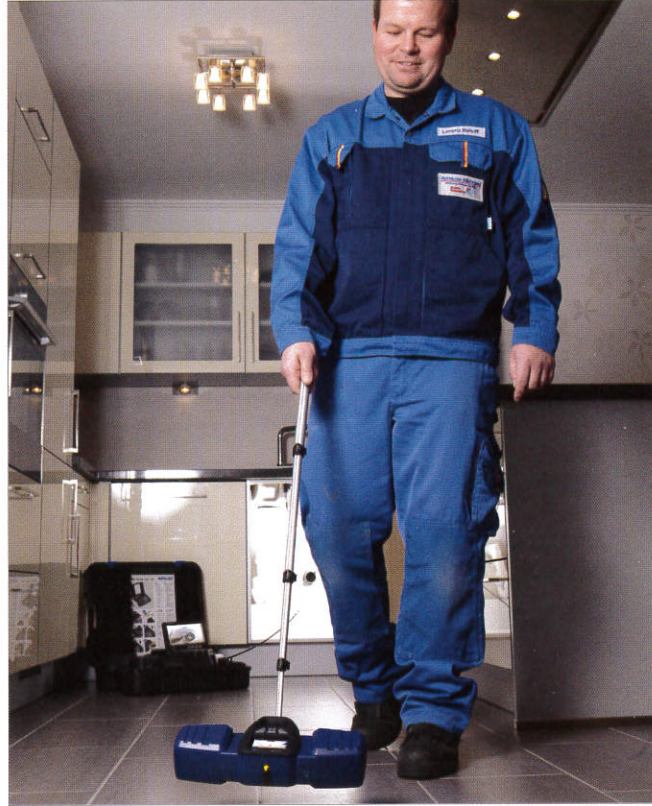
Neben der digitalen Meterzählung wird im Display zusätzlich die Lage des Kopfes angezeigt. Eine Funkortung ist mit dem Wöhler L 200 Locator möglich.
