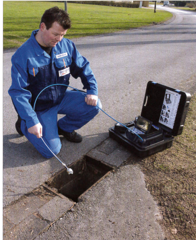
Mit der 20 m langen Schubstange und dem dreh- und schwenkbaren Farbkamerakopf entgeht Ihnen auch in der Hausanschlußleitung nichts.
