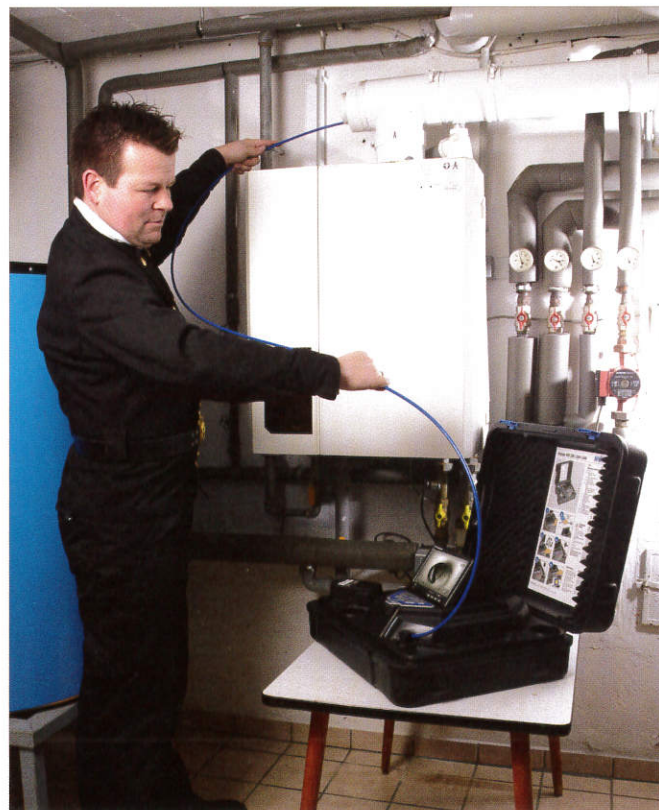
87°-Bögen werden von dem Farbkamerakopf, der um 360° drehbar und um 180° schwenkbar ist, spielend gemeistert.
