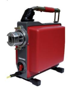
Die RAK 41 ist für NW 30 - 250 mm und Spiralen von 16 - 32 mm Durchmesser geeignet. 41-88 Spannbacken für 16 mm Spirale. Mit einem Adaptermagazin auch für 8 mm und 10 mm Spiralen und mit Spannbackenwechsel 16 mm für 16 mm Spiralen verwendbar.
