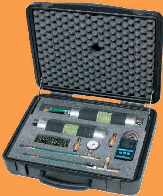
Dieses Prüfset ist für Dichtheitsprüfungen der Rohrleitungen von 80–150 mm Nennweite mit Luft bestimmt. Es eignet sich sowohl für gerade Rohrabschnitte als auch für Bögen und Knierohre bis zu 90°. Das Set beinhaltet alle für Dichtheitsprüfungen nach DIN EN 1610 erforderlichen Armaturen und Zubehörteile.
